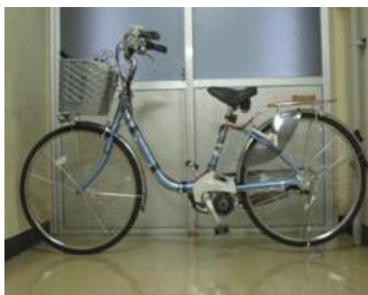
(a) 二輪電動アシスト式自転車 (b) 三輪電動アシスト式自転車
